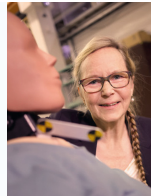
Professor Astrid Linder, VTI, tillsammans med den kvinnliga krocksäkerhetsmodellen SET50F som hon har utvecklat inom EU-projektet VIRTUAL.
