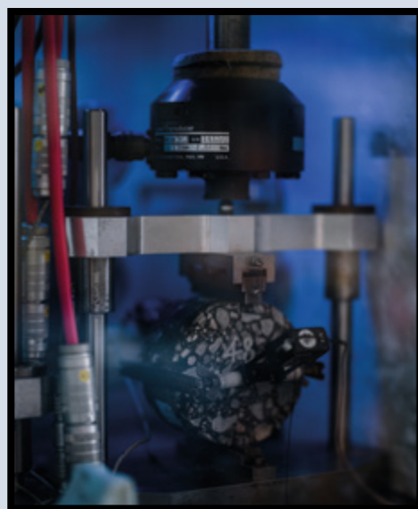
En provkropp av asfalt riggad för utmattningsförsök.
